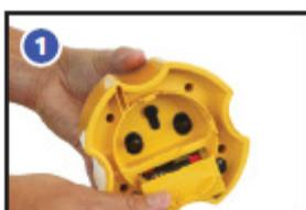
1 Retirez le module de piles en tournant les deux attaches et en retirant le compartiment à piles. Desserrez les vis si nécessaire
