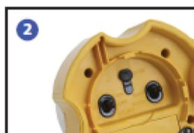
2 Retirez l'œillet en caoutchouc sur la prise de recharge indiquant '12V DC'
