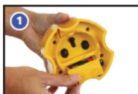
1 Assurez-vous que les 6 piles rechargeables AA (1.5V) sont correctement insérées dans le compartiment à piles
