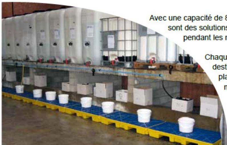
Avec une capacité de 80 litres, les plates-formes de rétention à 2 fûts sont des solutions rentables pour contenir des déversements pendant les manoeuvres de remplissage et de vidange des fûts.
